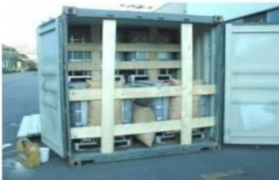
Hình 5.2. Minh họa về các thùng hàng tải trọng trung bình được chồng đôi trong công te nơ
