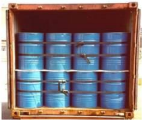
Hình 5.1. Minh họa về những thùng hàng rời được xếp 2 chồng trong công te nơ, 2 lớp và 4 hàng
