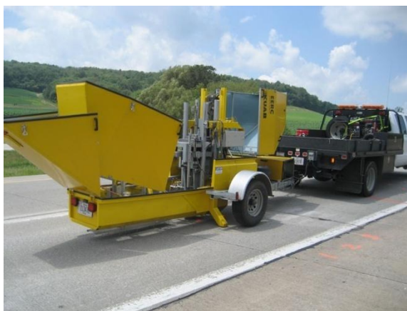
Hình 17 – Xác định rỗng, hờ đáy tấm BTXM bằng thiết bị đo động FWD
